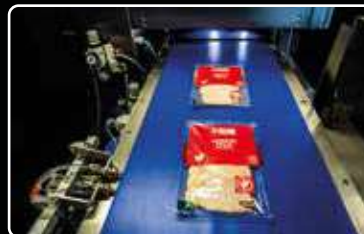
Inspección de soldaduras y etiquetas
